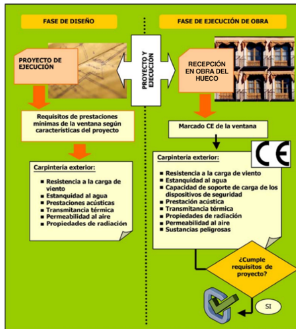
Figura 3. Marcado CE y CTE en huecos
