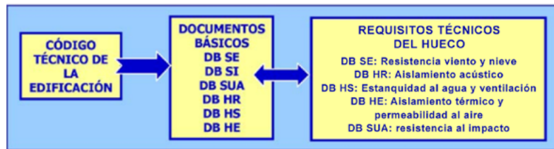
Figura 2. Prestaciones del hueco
