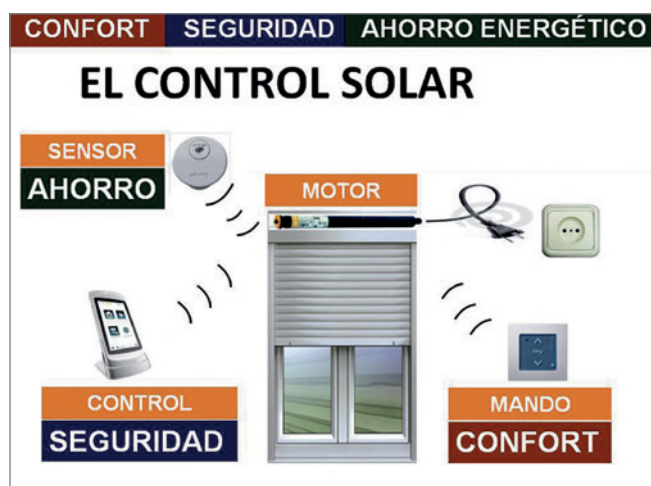
Figura 137. Esquema de control solar en una vivienda
