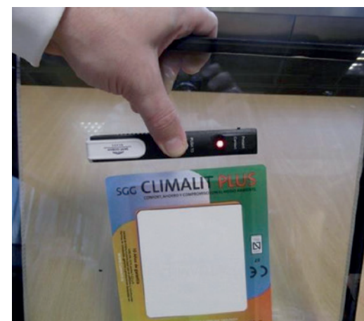
Figura 156. Dispositivo para identificación de vidrio de capas
