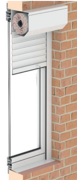
Figura 92. Detalle cajón de persiana por el exterior
