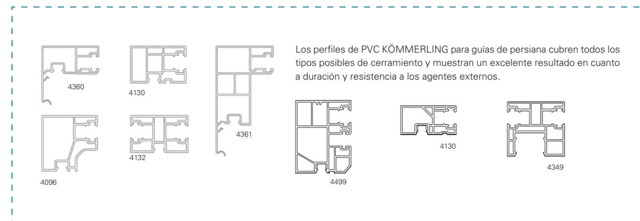
Los perfiles de PVC KÖMMERLING para guías de persiana cubren todos los tipos posibles de cerramiento y muestran un excelente resultado en cuanto a duración y resistencia a los agentes externos.
