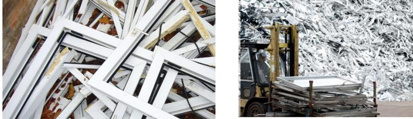
Figura 6.4 Material acumulado para el reciclaje de perfiles de PVC (izquierda) y Aluminio (derecha)
