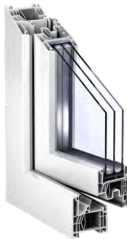
KÖMMERLING76 MD Xtrem es el sistema más **eficiente y sofisticado** de KÖMMERLING. Con una compleja geometría interna y 6 cámaras de aire, obtiene el máximo nivel de aislamiento térmico para un sistema de solo 76 mm de espesor.
